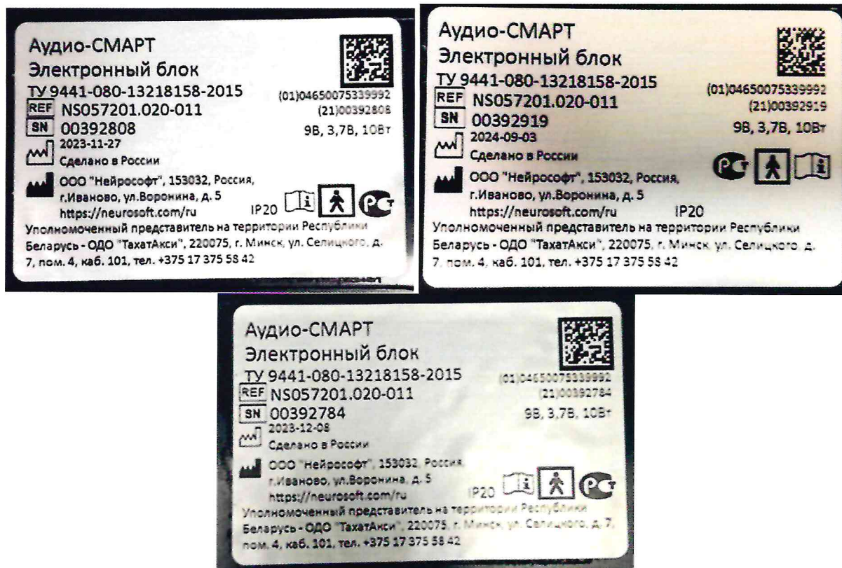
Рисунок 1.7 – Фотография маркировки блока электронного системы для ОАЭ, КСВП, импедансометрии и аудиологического скрининга «Аудио-СМАРТ» (изображение носит иллюстративный характер)
