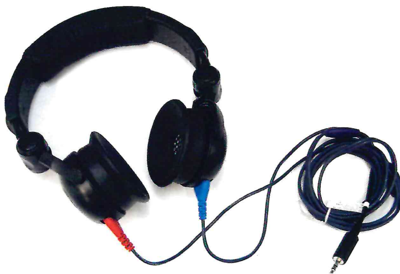
Рисунок 1.7 – Фотография общего вида слухового стимулятора «TDH-39P» системы для ОАЭ, КСВП, импедансометрии и аудиологического скрининга «Аудио-СМАРТ» (изображение носит иллюстративный характер)
