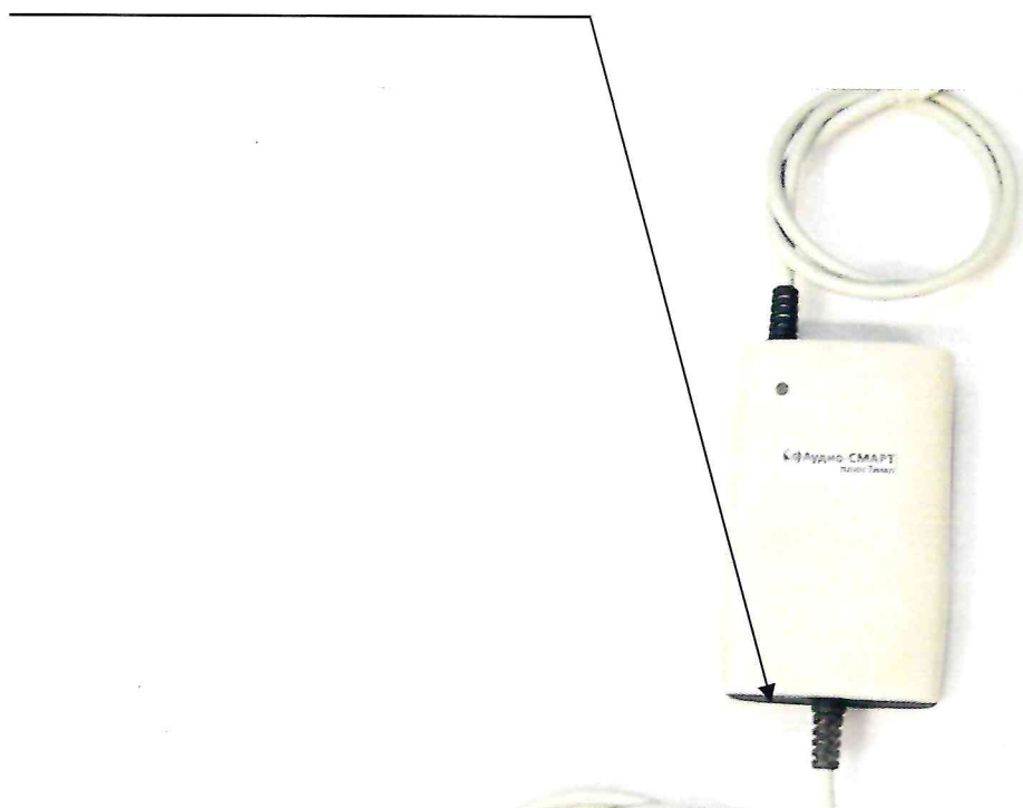
Рисунок 3.2 – Схема пломбировки от несанкционированного доступа блока импедансометрии
