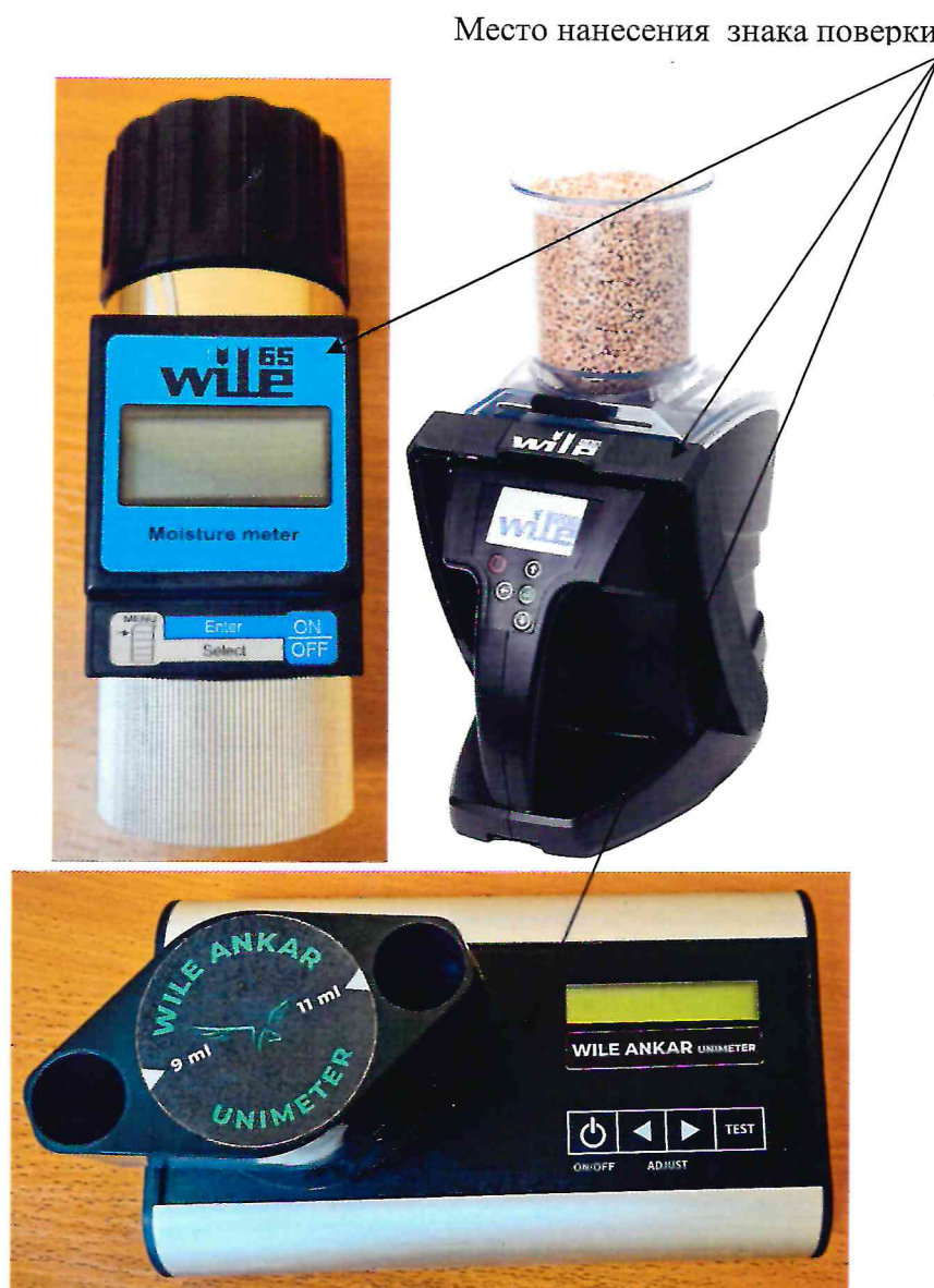
Рисунок 2.1 – Схема (рисунок) с указанием места для нанесения знака поверки средства измерений
