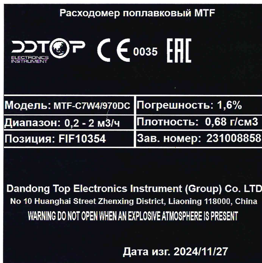
Рисунок 1.2 – Фотография маркировки расходомера поплавкового MTF-C7W4/970DC № 231008858
