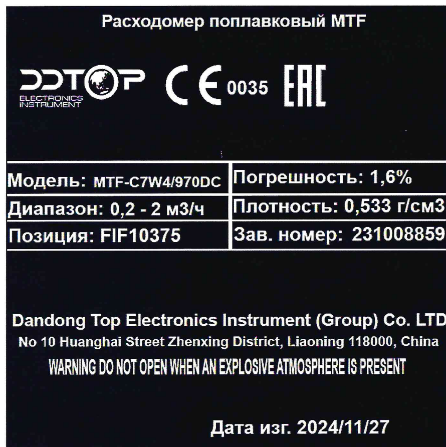
Рисунок 1.2 – Фотография маркировки расходомера поплавкового MTF-C7W4/970DC № 231008859
