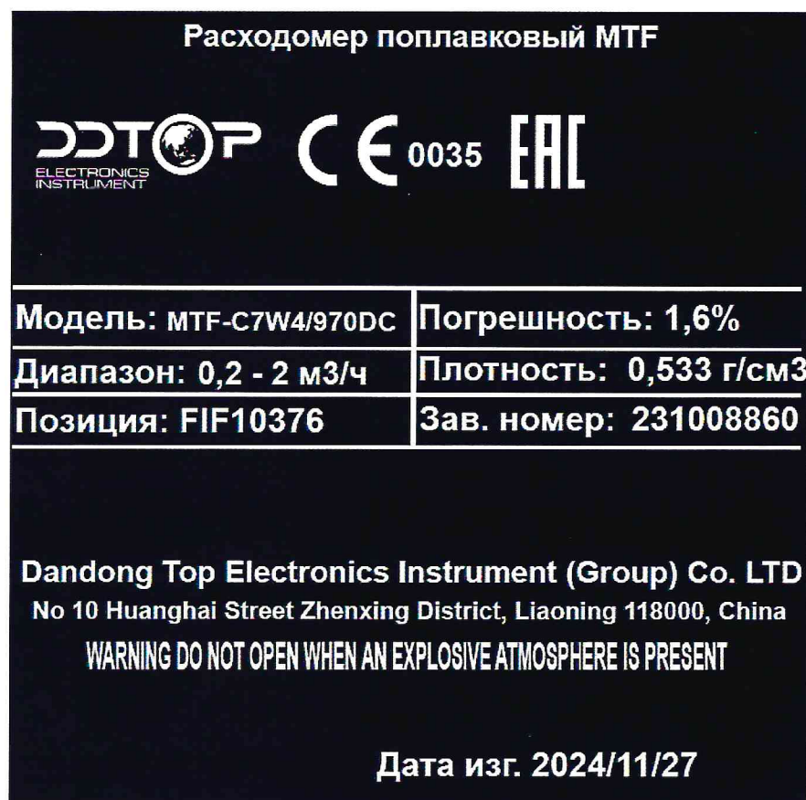
Рисунок 1.2 – Фотография маркировки расходомера поплавкового MTF-C7W4/970DC № 231008860
