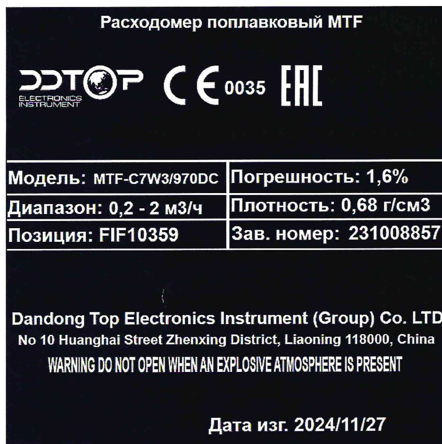
Рисунок 1.2 – Фотография маркировки расходомера поплавкового MTF-C7W3/970DC № 231008857
