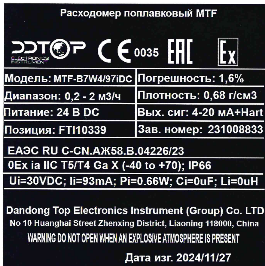
Рисунок 1.2 – Фотография маркировки расходомера поплавкового MTF-B7W4/97iDC № 231008833
