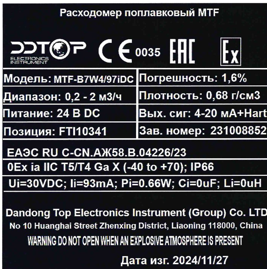
Рисунок 1.2 – Фотография маркировки расходомера поплавкового MTF-B7W4/97iDC № 231008852
