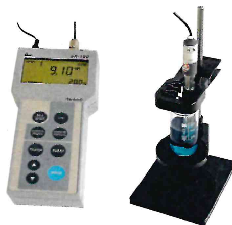
Рисунок 1.2 – Фотографии общего вида рХ-метра рХ-150
