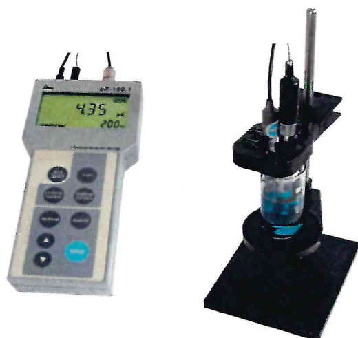
Рисунок 1.3 – Фотографии общего вида рХ-метра рХ-150.1
