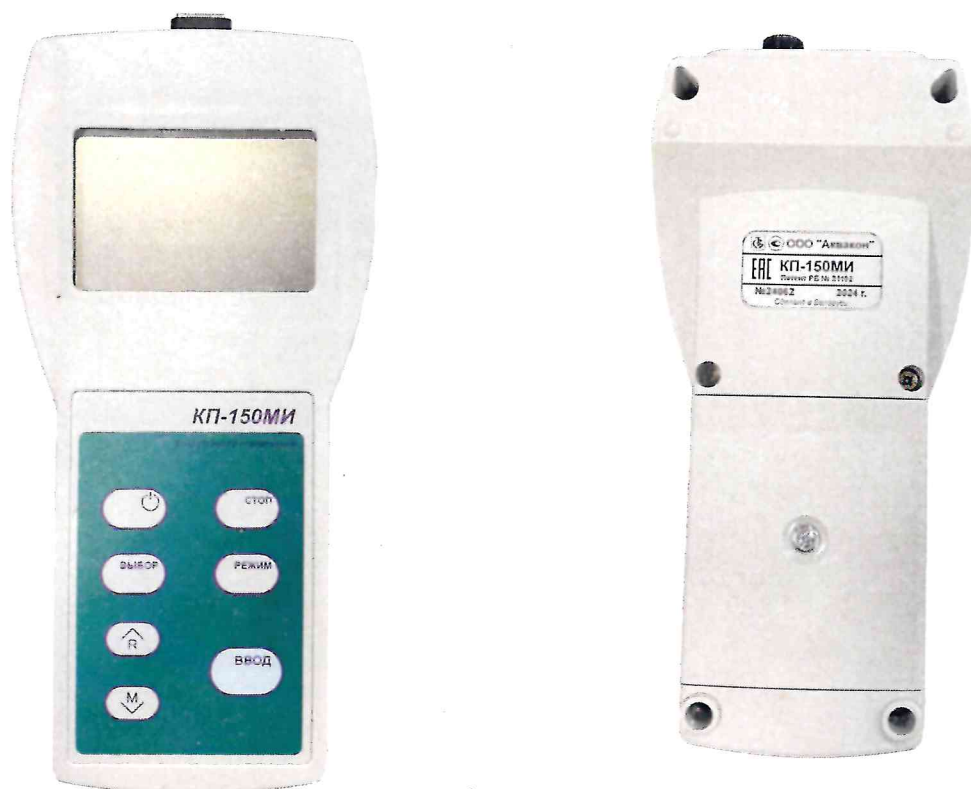
Рисунок 1.1 – Фотография общего вида кондуктометра портативного КП-150МИ
