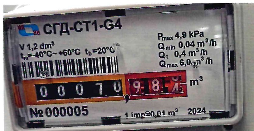
Рисунок 1.5 – Фотография маркировки счетчиков газа двухкамерных СГД-С (изображение носит иллюстративный характер)
