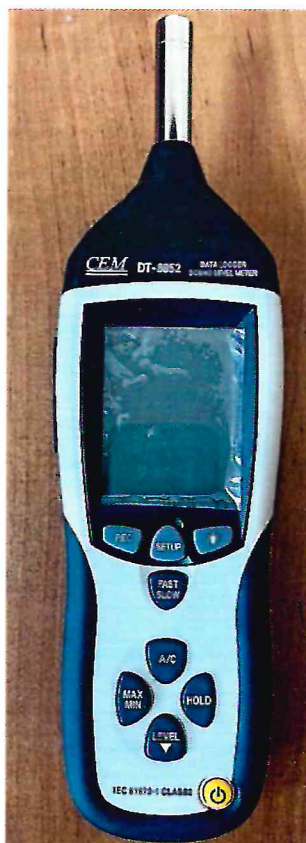
Рисунок 1.1 – Фотография общего вида измерителя уровня звука DT-8852 № 201010513
