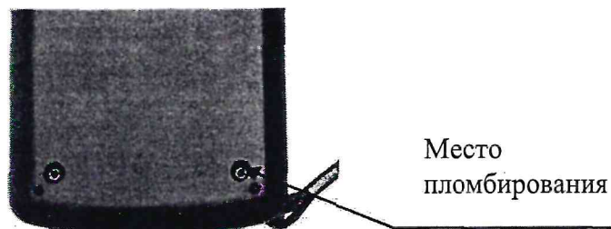
Рисунок 2 - Место пломбирования и клеймения влагомеров модификации ВИМС-2.21
