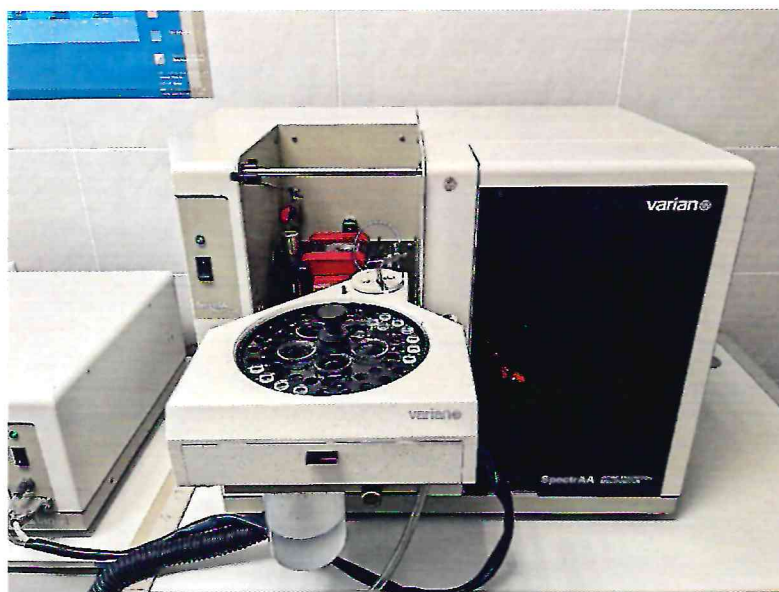
Рисунок 1.1 – Фотография общего вида спектрометра атомно-абсорбционный SpectrAA 220Z № EL97123124
