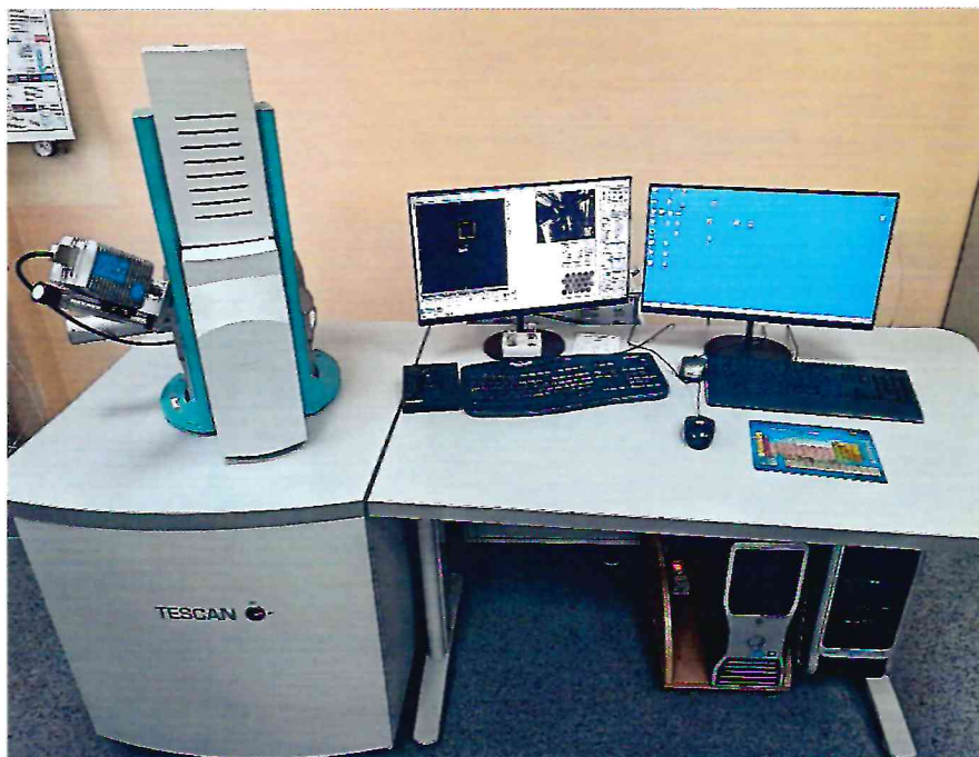
Рисунок 1.1 – Фотография общего вида системы рентгеновского энергодисперсионного микроанализа Quantax № 4585
