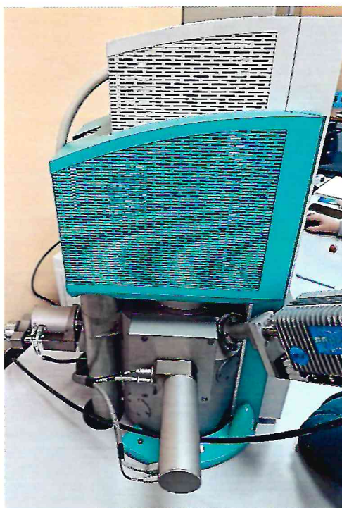
Рисунок 1.2 – Фотография общего вида блока энергодисперсионного детектора рентгеновского излучения XFlash®
