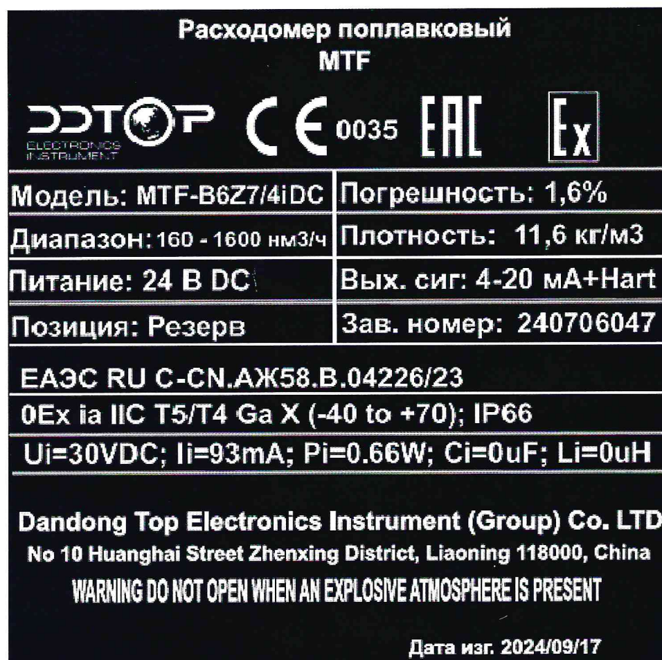
Рисунок 1.2 – Фотография маркировки расходомера поплавкового MTF-B6Z7/4iDC № 240706047
