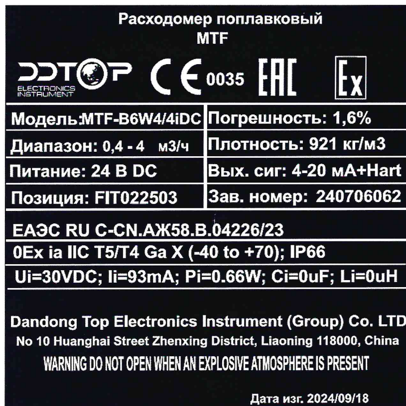
Рисунок 1.2 – Фотография маркировки расходомера поплавкового MTF-B6W4/4iDC № 240706062
