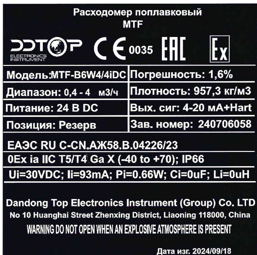
Рисунок 1.2 – Фотография маркировки расходомера поплавкового MTF-B6W4/4iDC № 240706058
