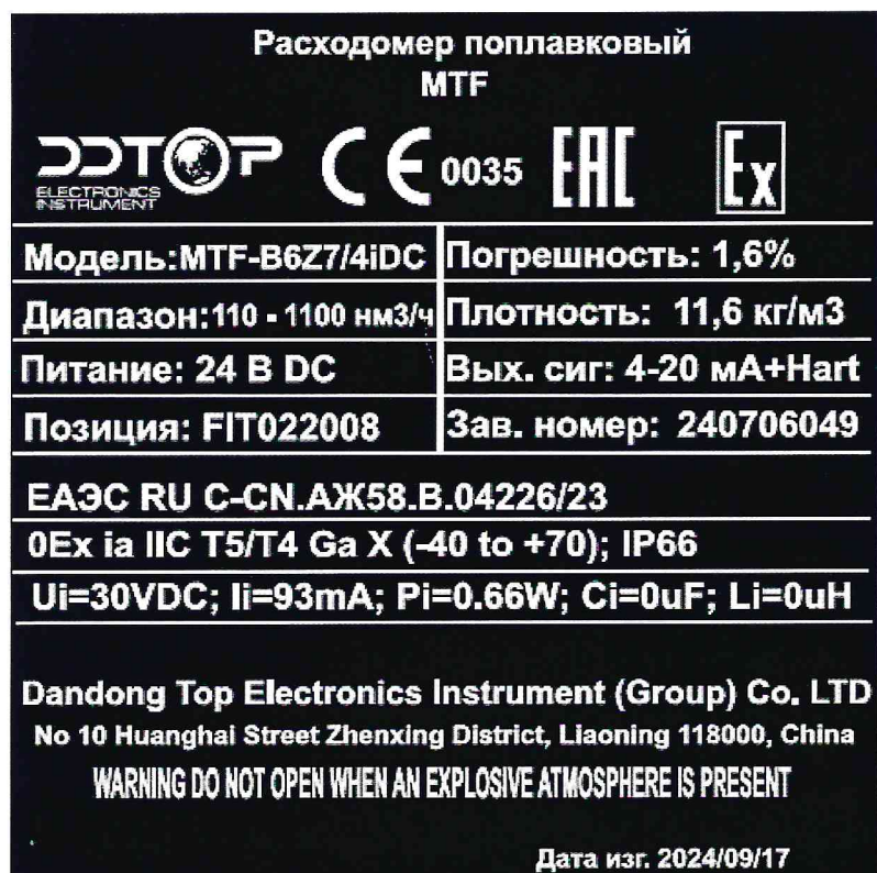
Рисунок 1.2 – Фотография маркировки расходомера поплавкового MTF-B6Z7/4iDC №240706049
