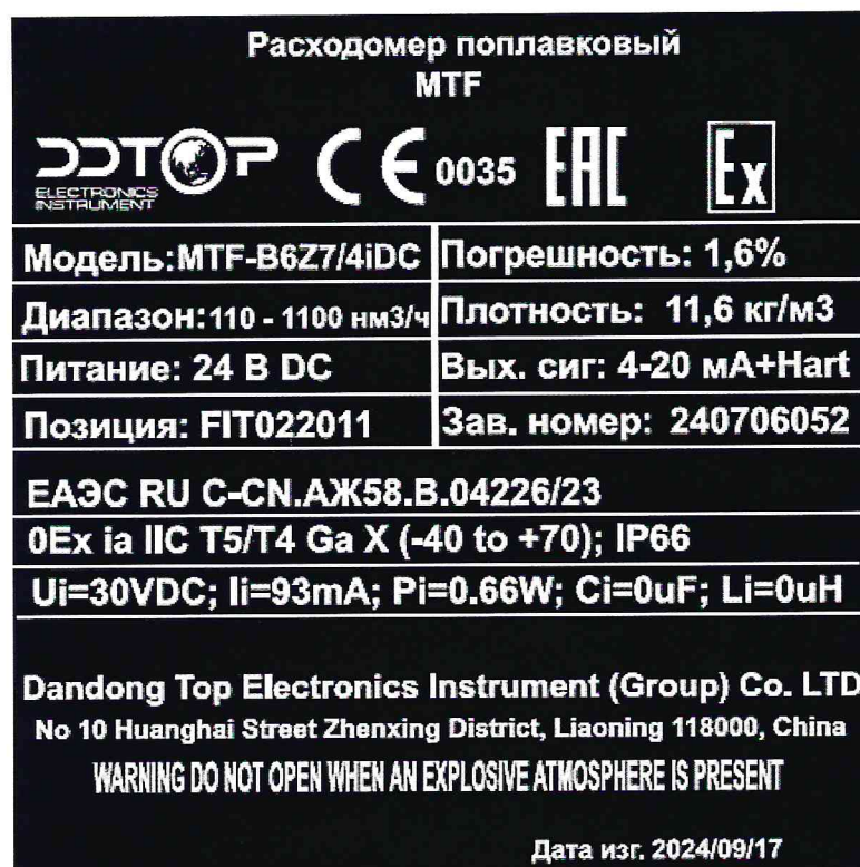
Рисунок 1.2 – Фотография маркировки расходомера поплавкового MTF-B6Z7/4iDC №240706052
