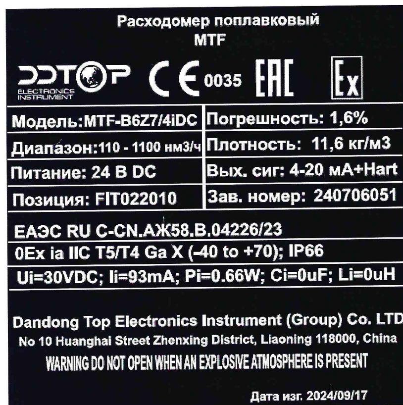
Рисунок 1.2 – Фотография маркировки расходомера поплавкового MTF-B6Z7/4iDC №240706051
