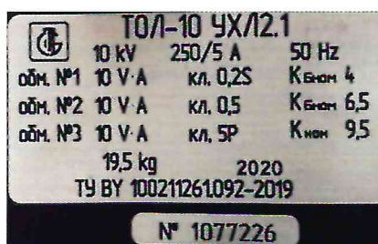
Рисунок 1.2 – Фотография маркировки трансформаторов тока ТОЛ-10 (изображение носит иллюстративный характер)
