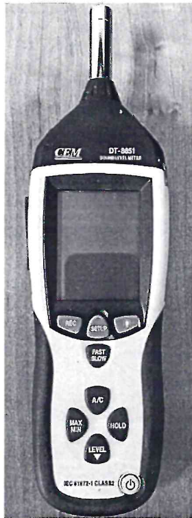
Рисунок 1.1 – Фотография общего вида измерителя уровня звука DT-8851 № 12036189
