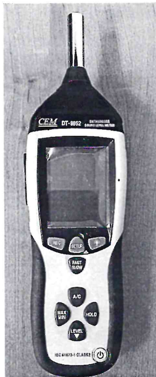
Рисунок 1.1 – Фотография общего вида измерителя уровня звука DT-8852 № 150301753
