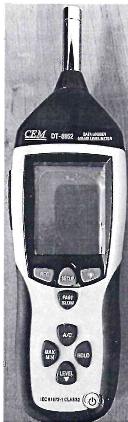
Рисунок 1.1 – Фотография общего вида измерителя уровня звука DT-8852 № 150816212
