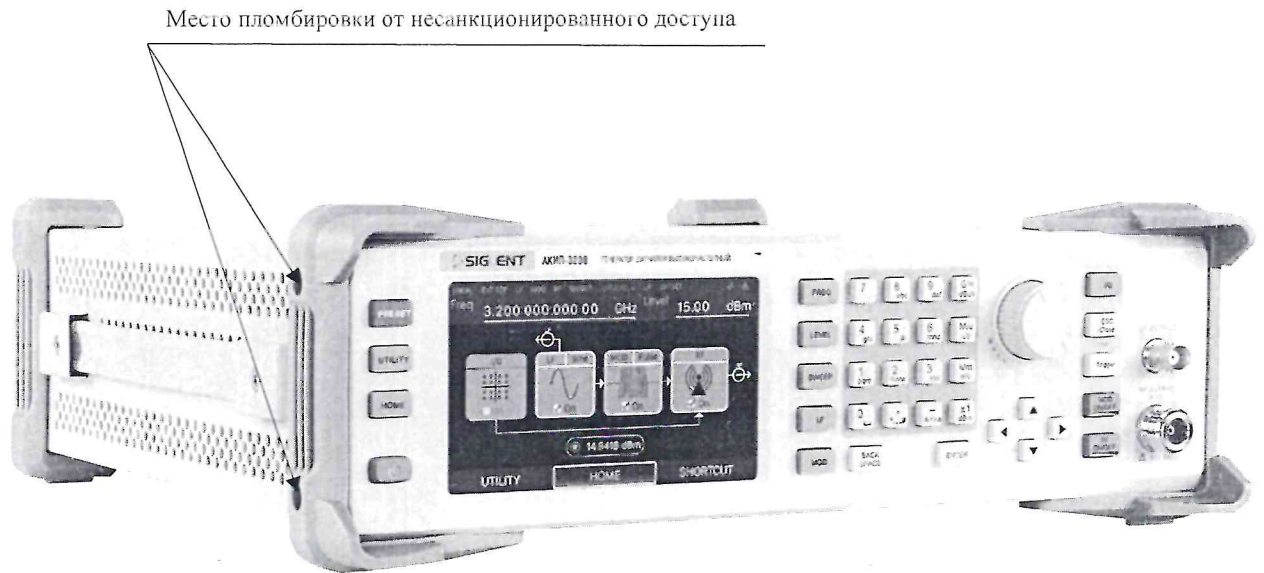
Рисунок 3.1 – Схема (рисунок) пломбировки от несанкционированного доступа
