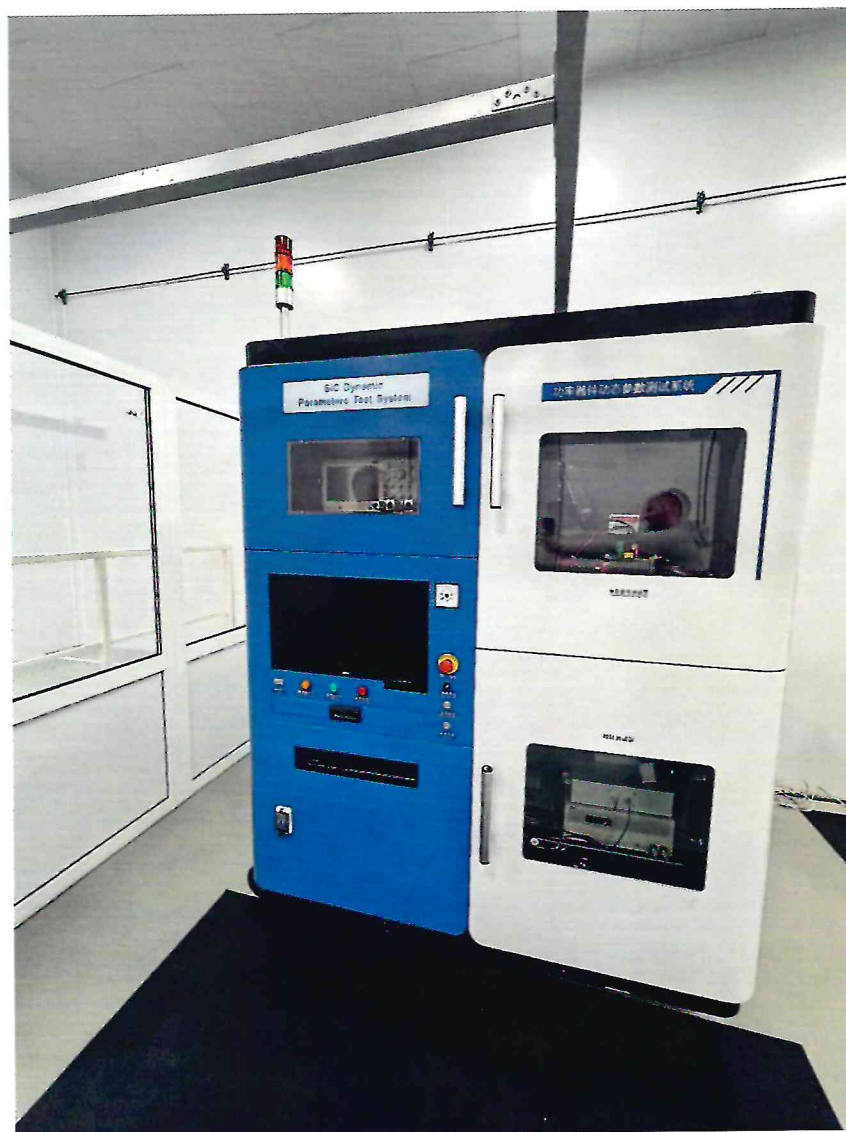
Рисунок 1.3 – Фотографии общего вида комплекса измерений динамических параметров PMDT входящего в состав анализатора автоматизированного тестирования силовых полупроводниковых приборов ДМТ-227 № 23191101
