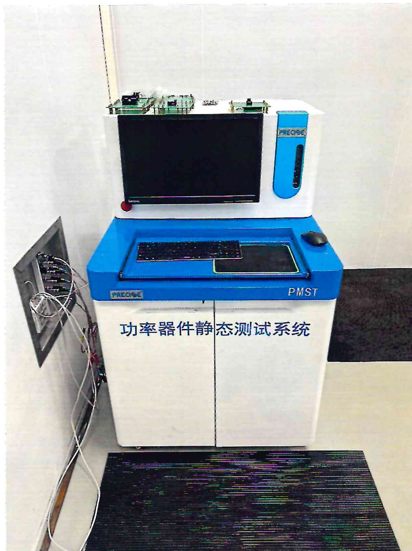
Рисунок 1.1 – Фотография общего вида комплекса измерения статических параметров PMST входящего в состав анализатора автоматизированного тестирования силовых полупроводниковых приборов ДМТ-227 № 23361101
