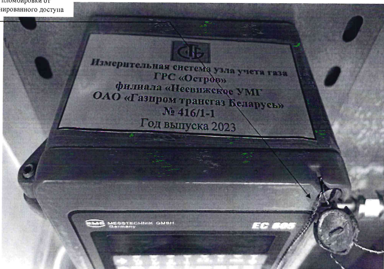
Рисунок 3.1 – Схема пломбировки от несанкционированного доступа
