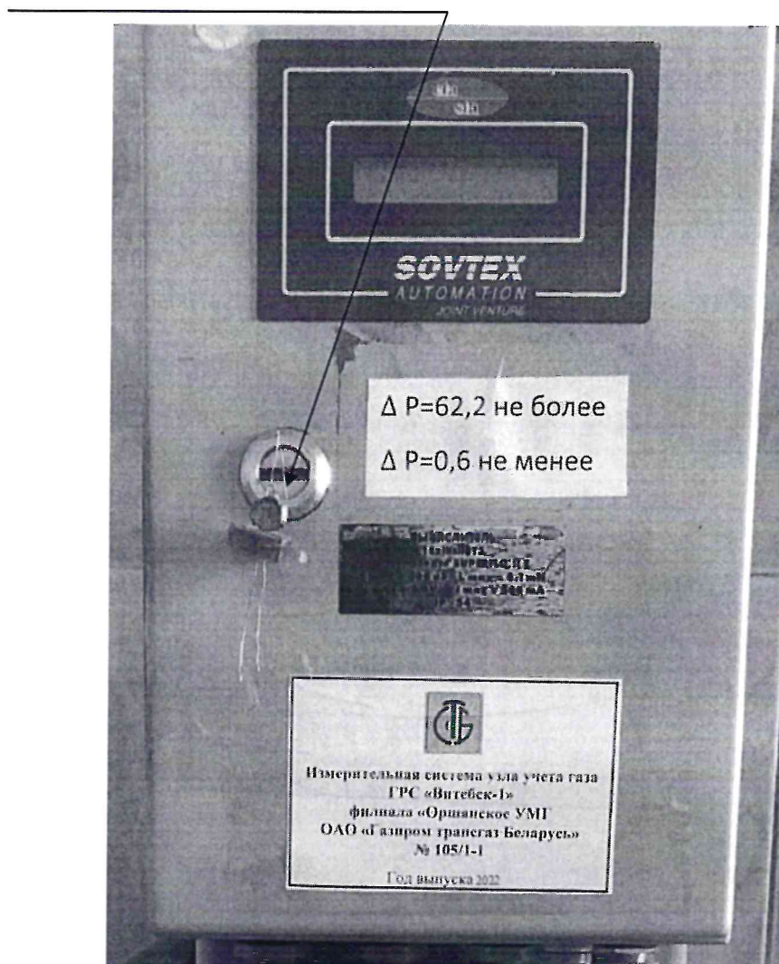
Рисунок 3.1 – Схема пломбировки от несанкционированного доступа
