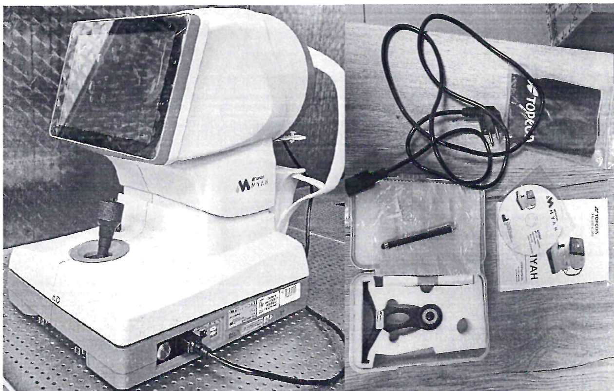
Рисунок 1.1– Фотография общего вида биометров офтальмологических с принадлежностями: анализатор роговицы с интегрированной функцией биометрии МУАН с принадлежностями (изображение носит иллюстративный характер)
