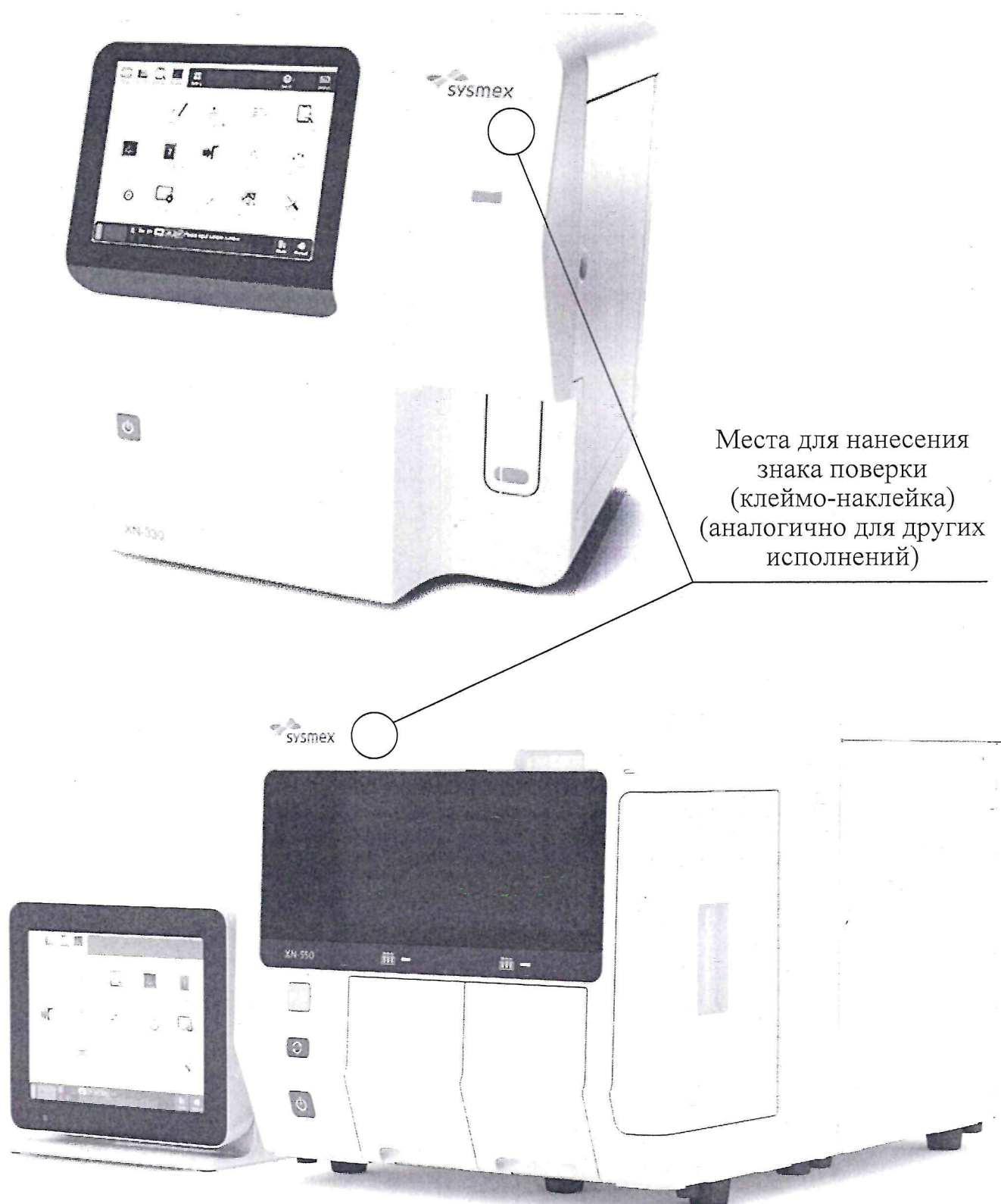
Рисунок 2.1 – Схема с указанием мест для нанесения знака поверки анализаторов автоматических гематологических серии XN-L
