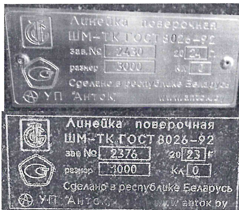
Рисунок 1.2 Фотографии маркировки линейки поверочной типа ШМ-ТК
