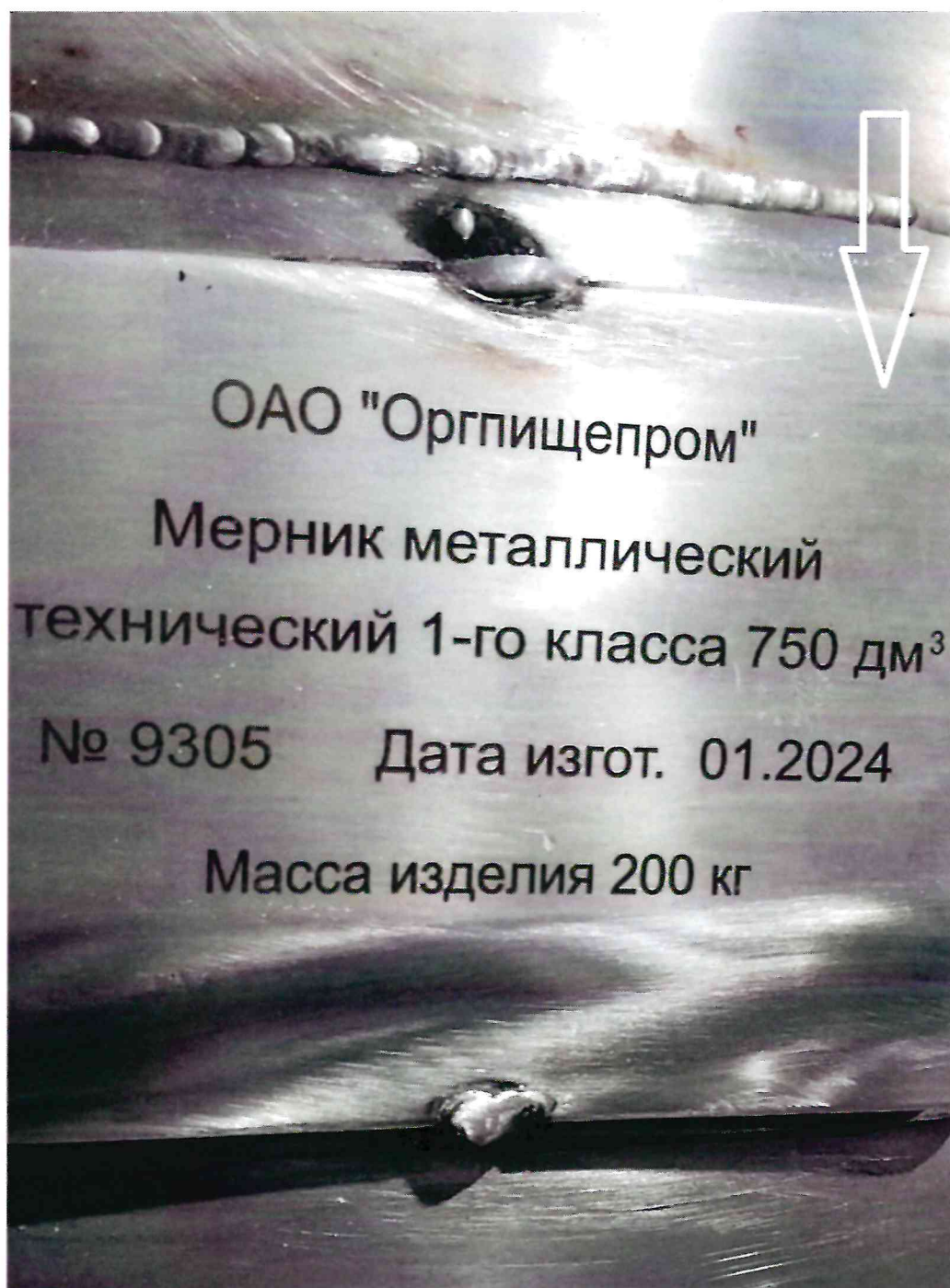
Рисунок 2 – Указание места для нанесения знака поверки мерника металлического технического 1-го класса 750 дм³ № 9305
