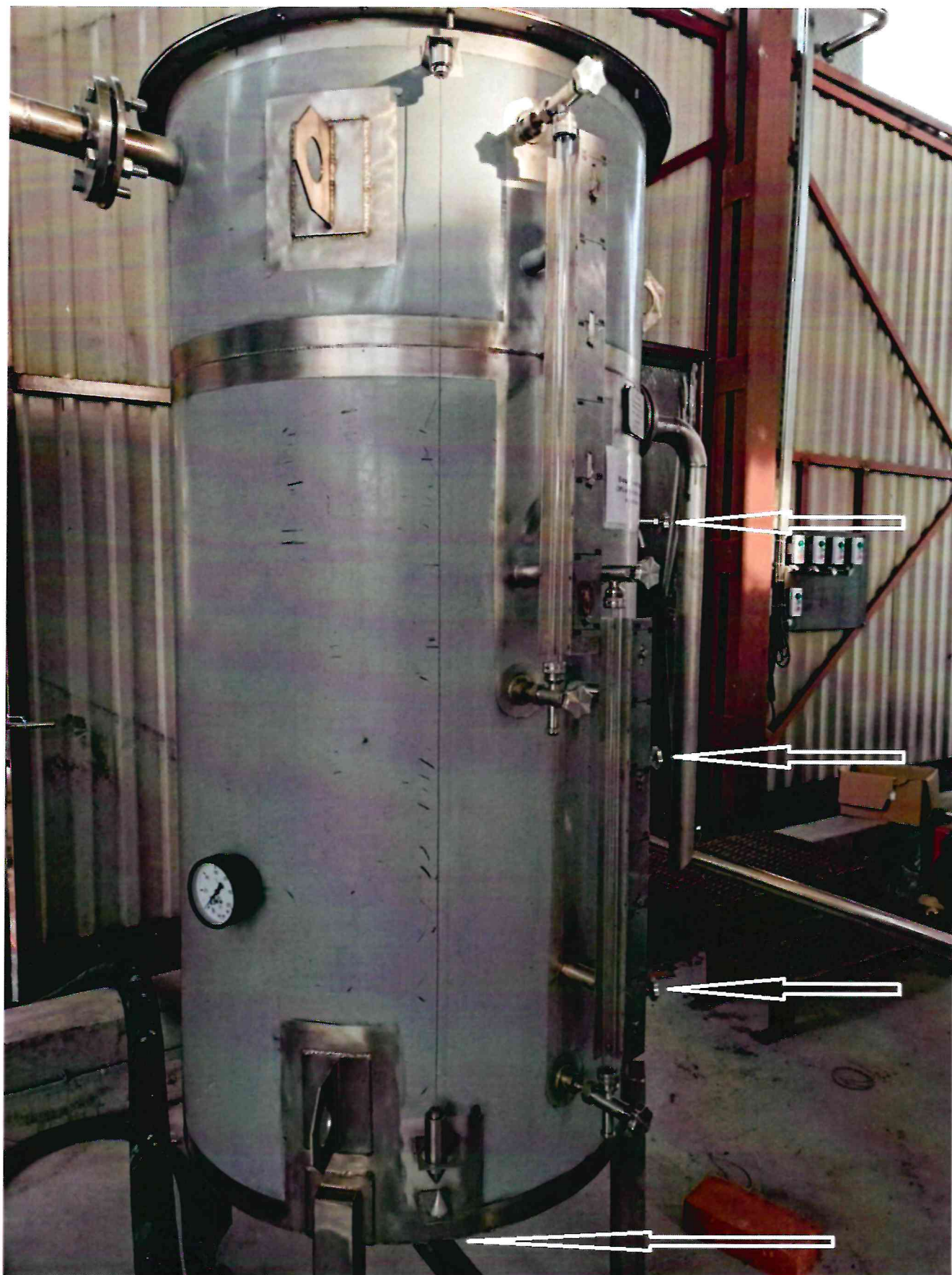
Рисунок 3 – Схема пломбировки от несанкционированного доступа мерника металлического технического 1-го класса 750 дм 3 № 9305
