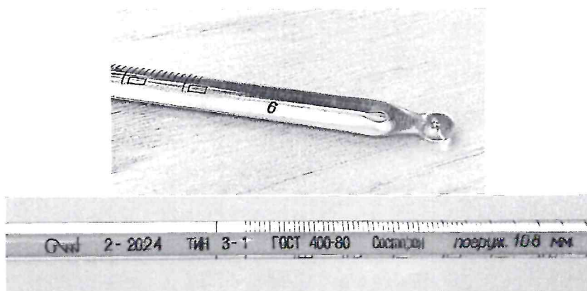
Рисунок 1.2 – Фотографии маркировки термометра стеклянного для испытаний нефтепродуктов ТИН 3-1 № 6
