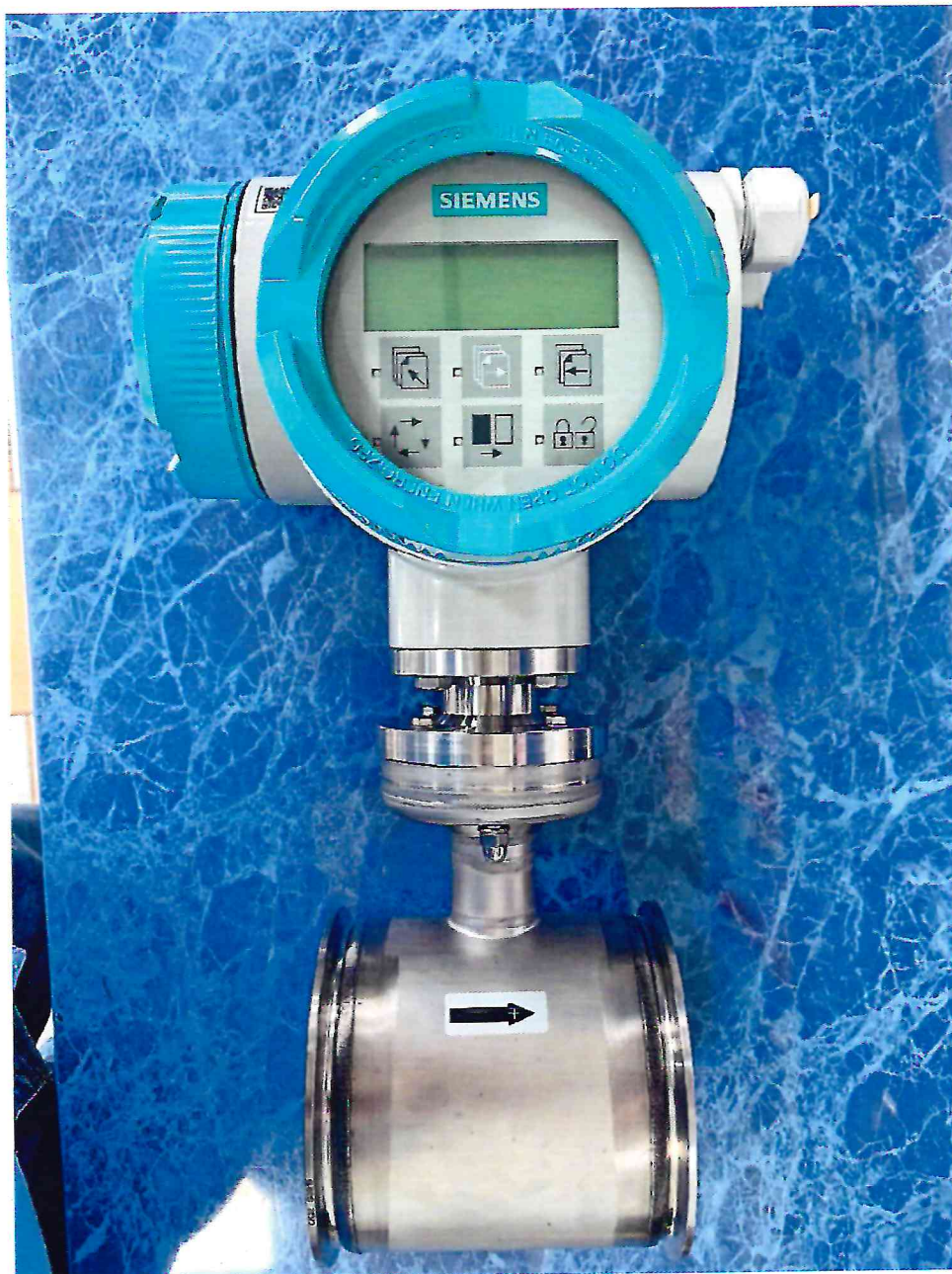
Рисунок 1.1 – Фотографии общего вида расходомера-счетчика электромагнитного SITRANS F M MAG 6000I/1100 F № 111215H064
