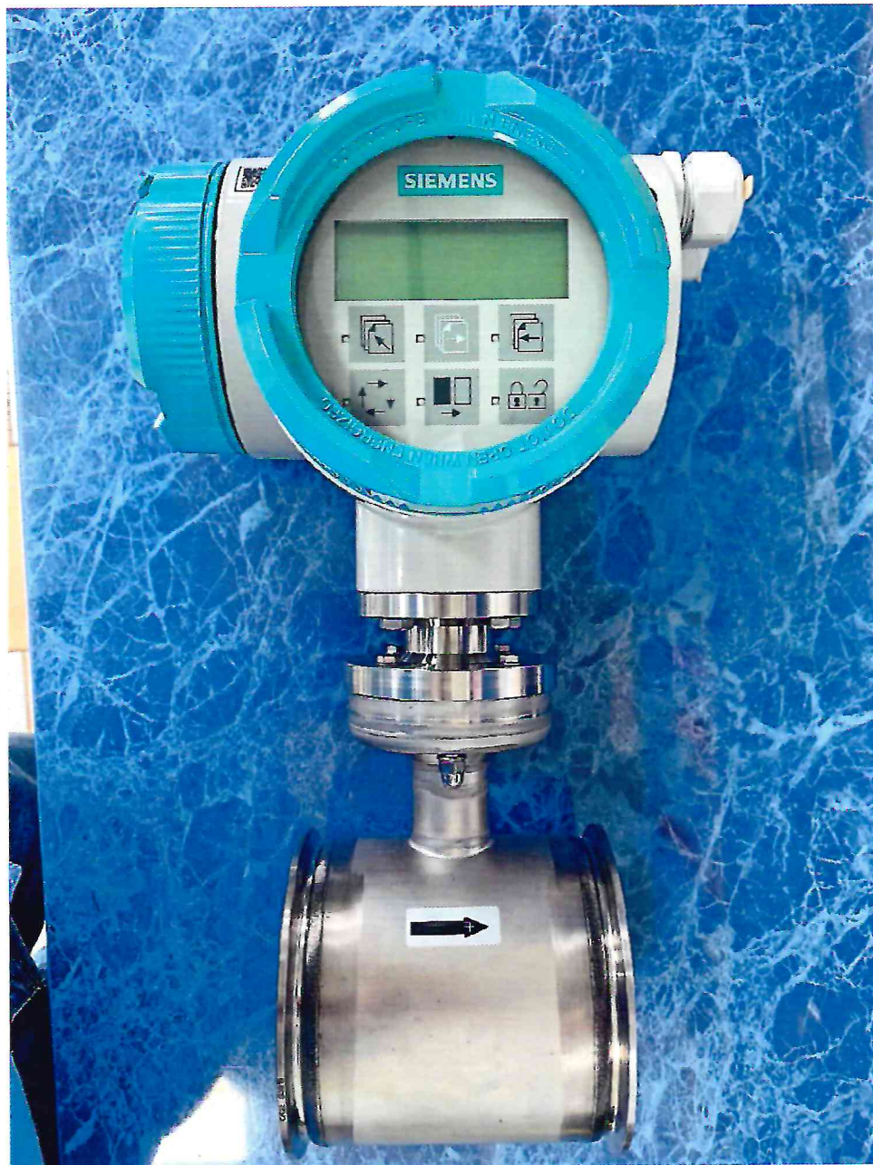
Рисунок 1.1 – Фотографии общего вида расходомера-счетчика электромагнитного SITRANS F M MAG 6000I/1100 F № 111115H064
