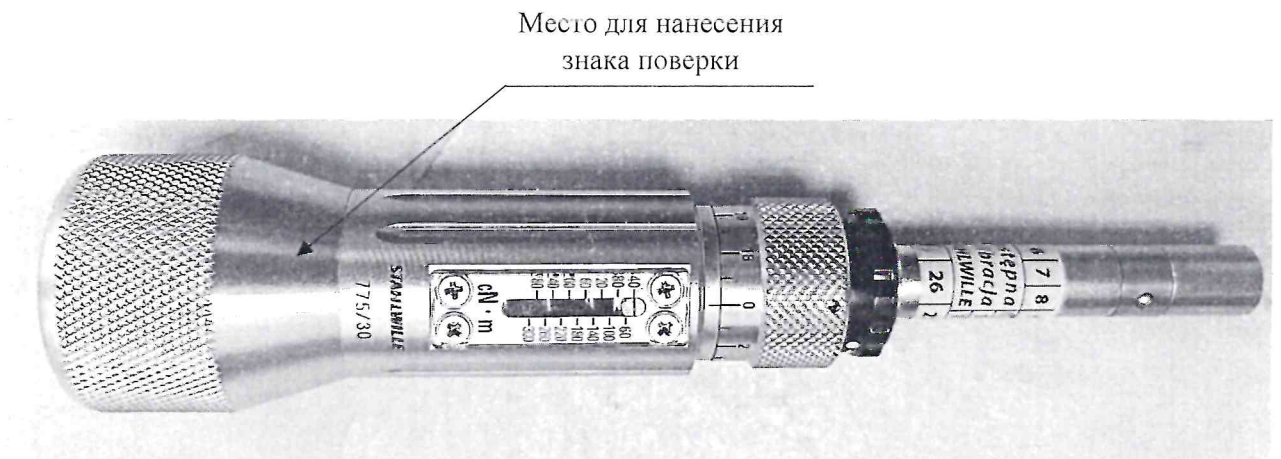
Рисунок 2.1 – Схема (рисунок) с указанием места для нанесения знака поверки
