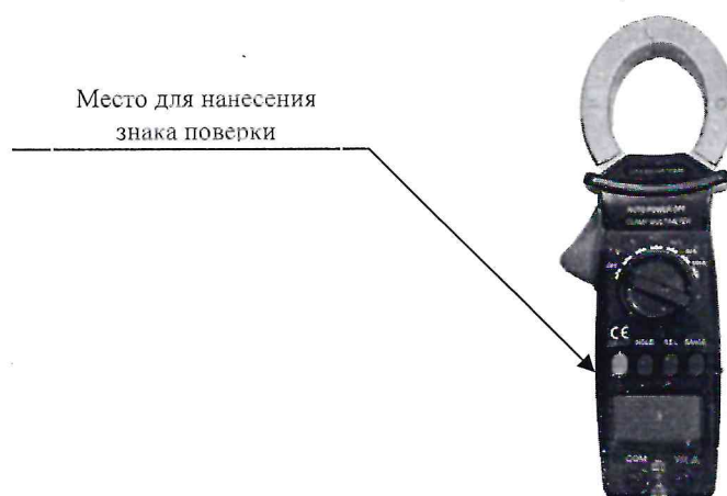
Рисунок 2.2 – Схема (рисунок) с указанием места для нанесения знака поверки клещей C635
