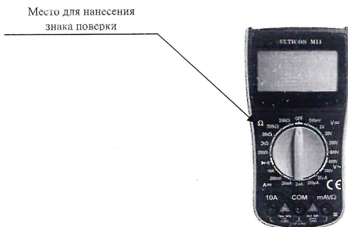
Рисунок 2.1 – Схема (рисунок) с указанием места для нанесения знака поверки мультиметра M11
