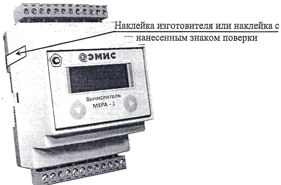
Рисунок 4 - Схема пломбировки вычислителя счетчиков раздельного исполнения
