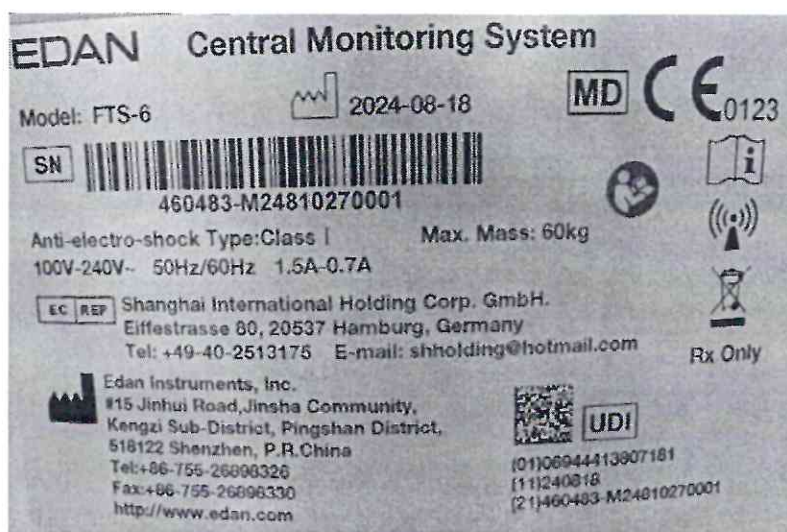
Рисунок 1.2 – Фотография маркировки системы мониторинга центральной FTS-6 (изображение носит иллюстративный характер)
