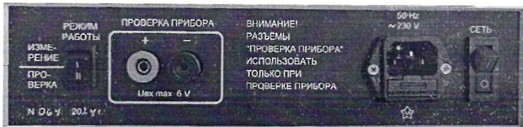
Рисунок 1.1 – Фотография общего вида прибора измерения параметров электрических средств взрывания КОПЕР-2 № 064
