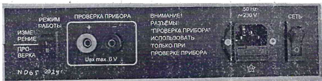
Рисунок 1.1 – Фотография общего вида прибора измерения параметров электрических средств взрывания КОПЕР-2 № 065
