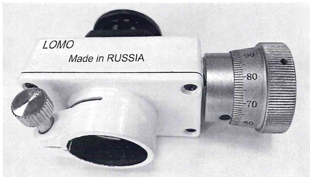
Рисунок 1.1 – Фотография общего вида микрометра окулярного винтового МОВ-1-16X № 200214
