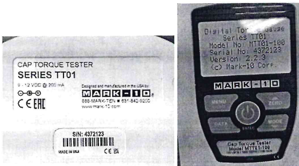
Рисунок 1.1 – Фотография общего вида цифрового измерителя крутящего момента крышек (торк-тестер) серия TT01 модель MTT01-100 № 4372123
