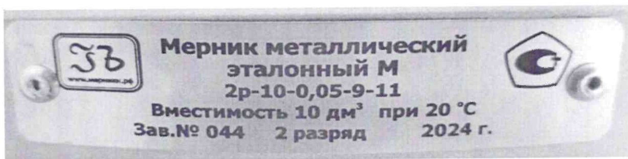
Рисунок 1.2 – Маркировка мерника металлического эталонного М 2-го разряда 2р-10-0,05-9-11 № 044
