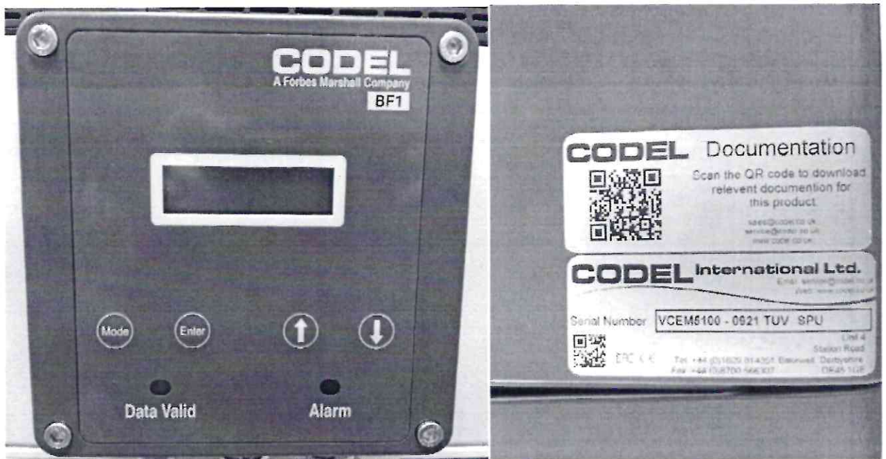
Рисунок 1.4 – Фотография устройства отображения данных. Измеритель скорости газоздушных потоков VCEM5100 № VCEM5100 – 0921 TUV SPU
