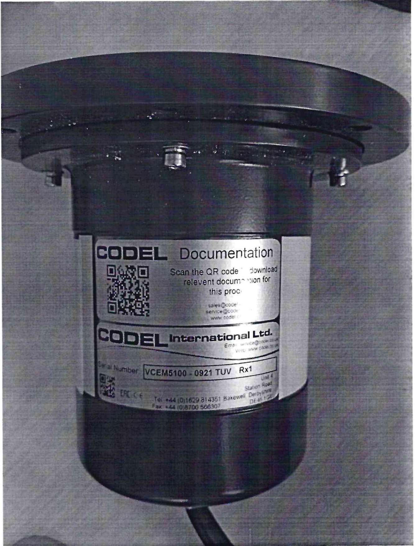
Рисунок 1.2 – Фотография первого инфракрасного датчика. Измеритель скорости газоздушных потоков VCEM5100 № VCEM5100 – 0921 TUV SPU
