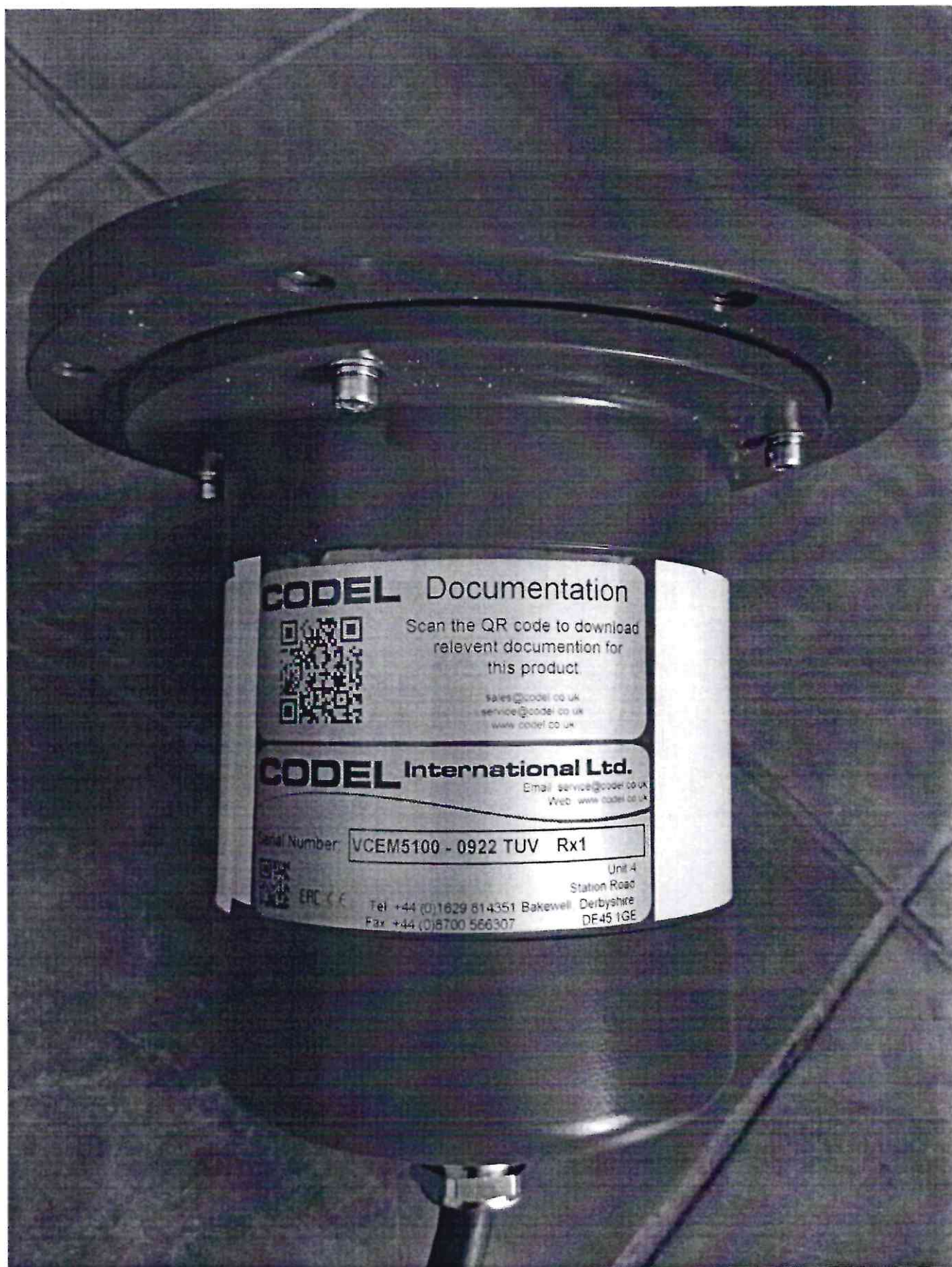
Рисунок 1.2 – Фотография первого инфракрасного датчика. Измеритель скорости газовоздушных потоков VCEM5100 № VCEM5100 – 0922 TUV SPU
