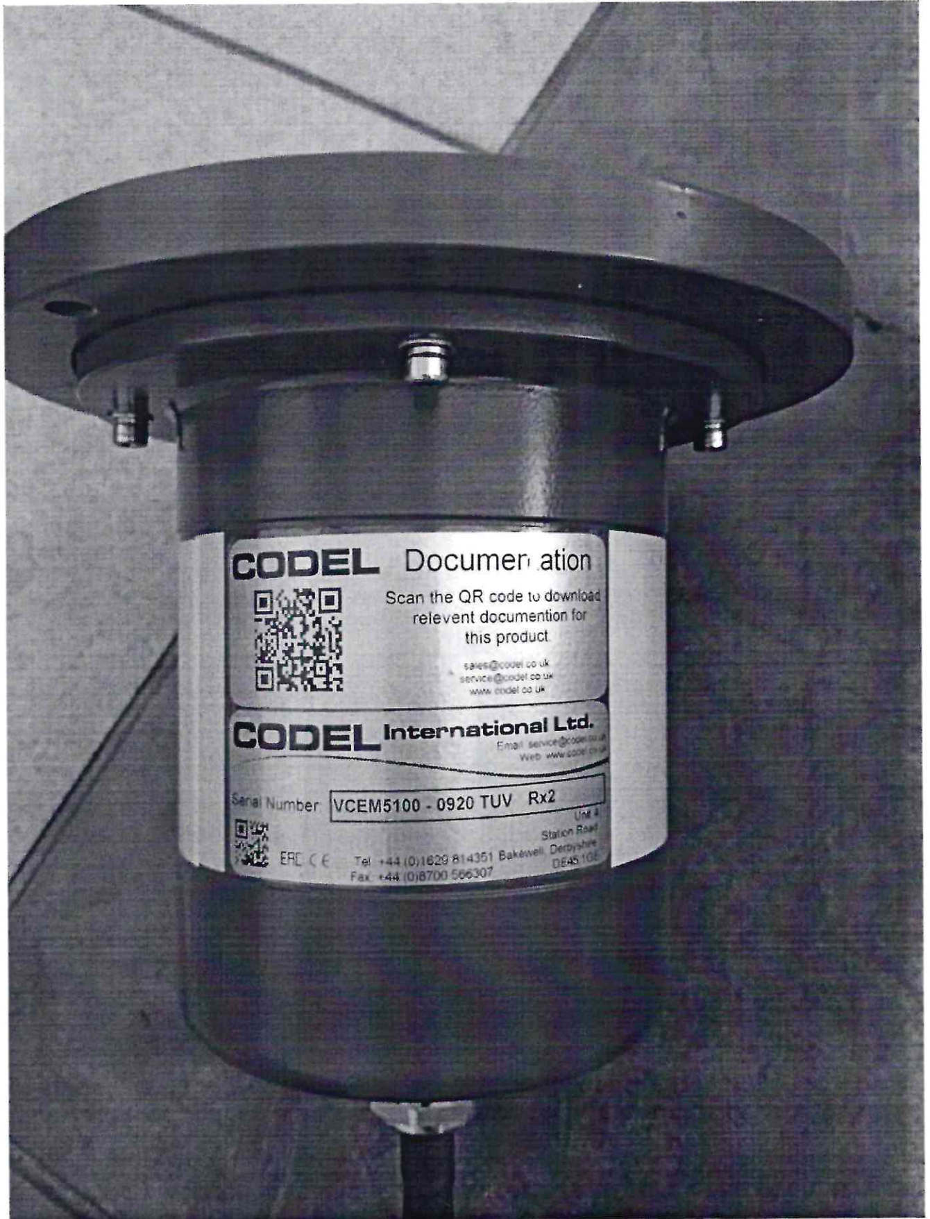
Рисунок 1.3 – Фотография второго инфракрасного датчика. Измеритель скорости газоздушных потоков VCEM5100 № VCEM5100 – 0920 TUV SPU
