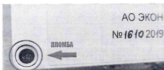
Рисунок 3 - Схема пломбировки от несанкционированного доступа, обозначение места нанесения знака поверки
